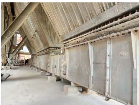
รูปที่ 2-4 ระบบสายพานแบบปิดเพื่อลำเลียงฝุ่นจาก P/H Boiler กลับเข้าสู่กระบวนการผลิต
