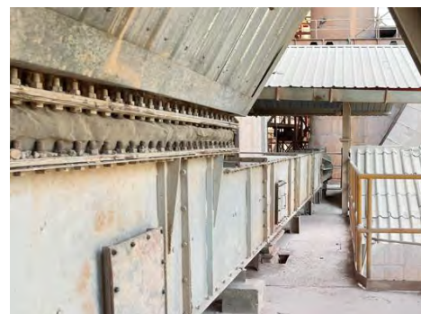
รูปที่ 2-4 ระบบสายพานแบบปิดเพื่อลำเลียงฝุ่นจาก P/H Boiler กลับเข้าสู่กระบวนการผลิต
