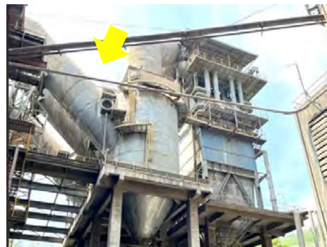
รูปที่ 2-27 ท่อนำความร้อนทิ้งจาก P/H Boiler และ Clinker Cooler โรงงาน 3 (สายการผลิตที่ 5 และ 6)
